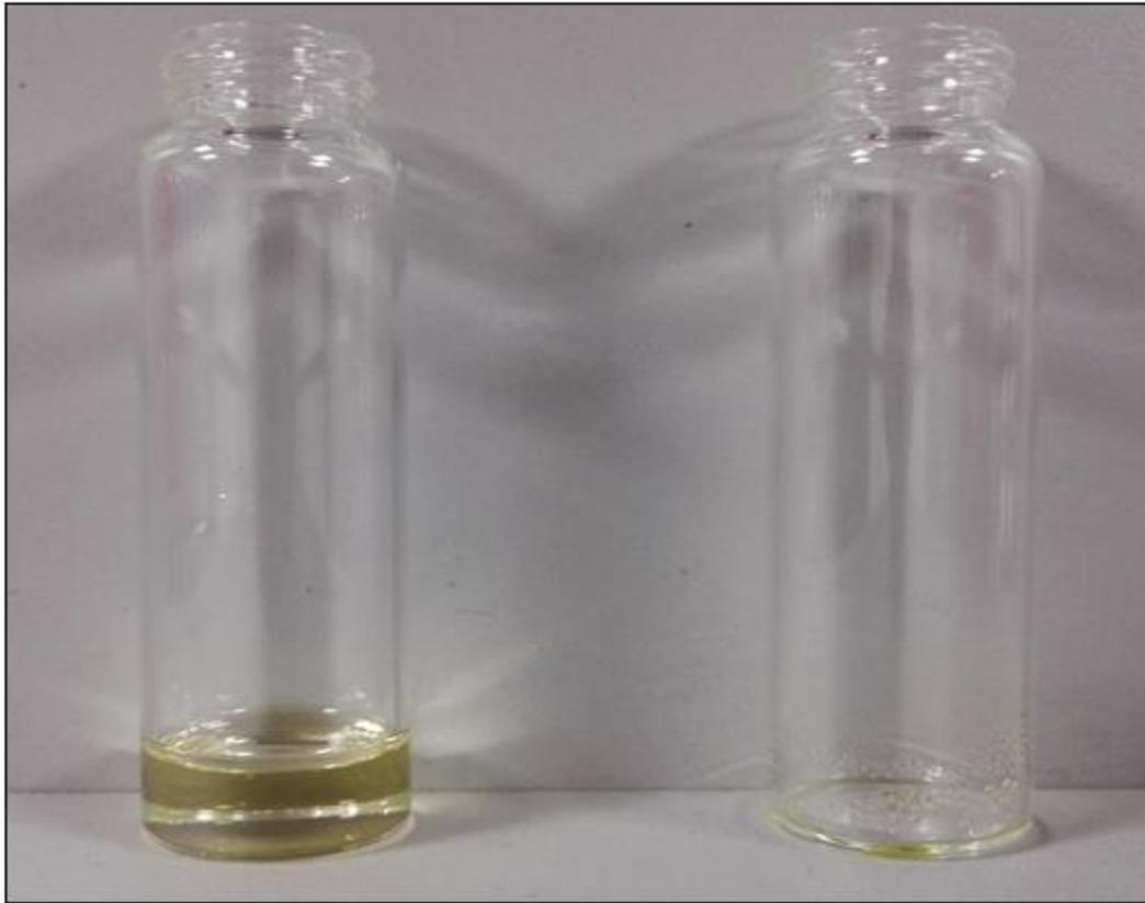
图 4. 乙腈提取后氮气吹干油样残留（左：1g 油样；右：净化后油样残留）
